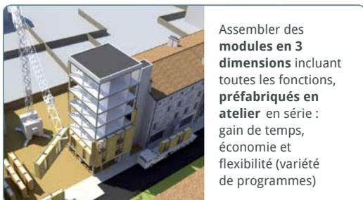
Assembler des **modules en 3 dimensions** incluant toutes les fonctions, **préfabriqués en atelier** en série : gain de temps, économie et flexibilité (variété de programmes)
