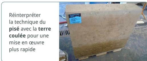
Réinterpréter la technique du **pisé** avec la **terre coulée** pour une mise en œuvre plus rapide
