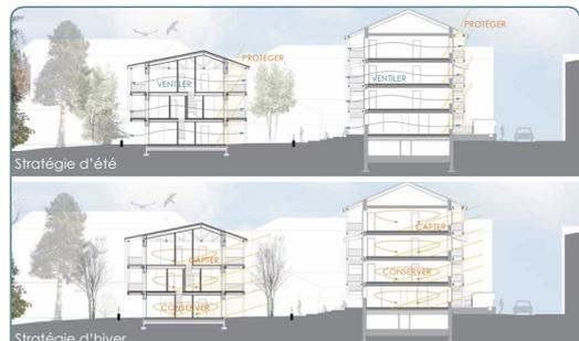
Associer amélioration thermique de l'existant et constructions neuves performantes énergétiquement avec des **stratégies passives** (isolation, inertie, porosité, compacité, protection solaire, ventilation)
